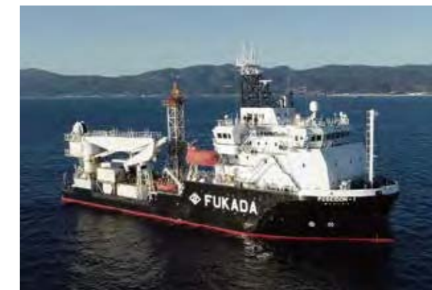
POSEIDON-1に搭載された洋上風力地盤調査用の小型リグ
