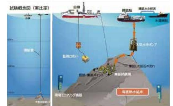
図-1 海底熱水鉱床採鉱・揚鉱パイロット試験 概念図
