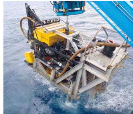
写真-3 Excavatorを艦装したROV「はくよう3000」
