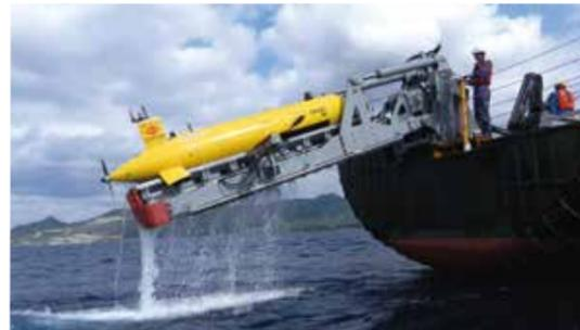
写真-1 AUV(自律型無人潜水機)「Deep1」
