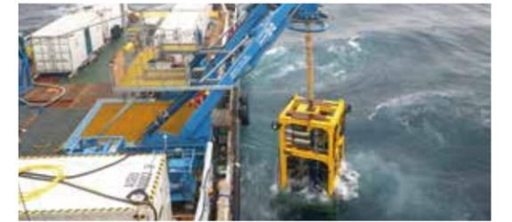
写真-5 海底着座式ボーリング機「Unicorn-1」
