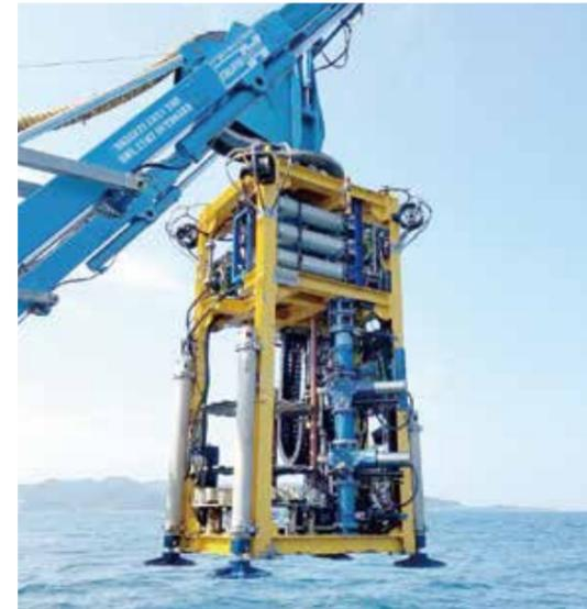
写真-4 海底着座式ボーリング機「Unicorn-1」
