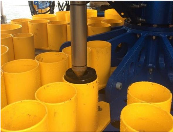
図-3 カルーセルの CPT ロッド格納カップ
